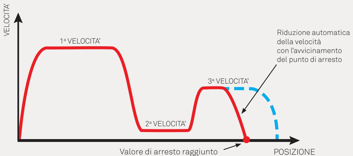
Lo strumento di controllo del sistema regola la velocità del cilindro in tempo reale usando come retroazione i trasduttori di forza e di posizione.
